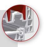
Mit dieser Technologie werden höchste Wärmedämmwerte erzielt. Hierbei kann auf die Stahlverstärkung im Inneren des Flügels und/oder des Rahmens verzichtet werden. Die Verstärkungskammer wird dann mit der proEnergyTec ausgeschäumt.
